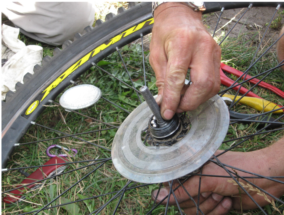
Фото 25. Засыпаем подшипники в колесо.
