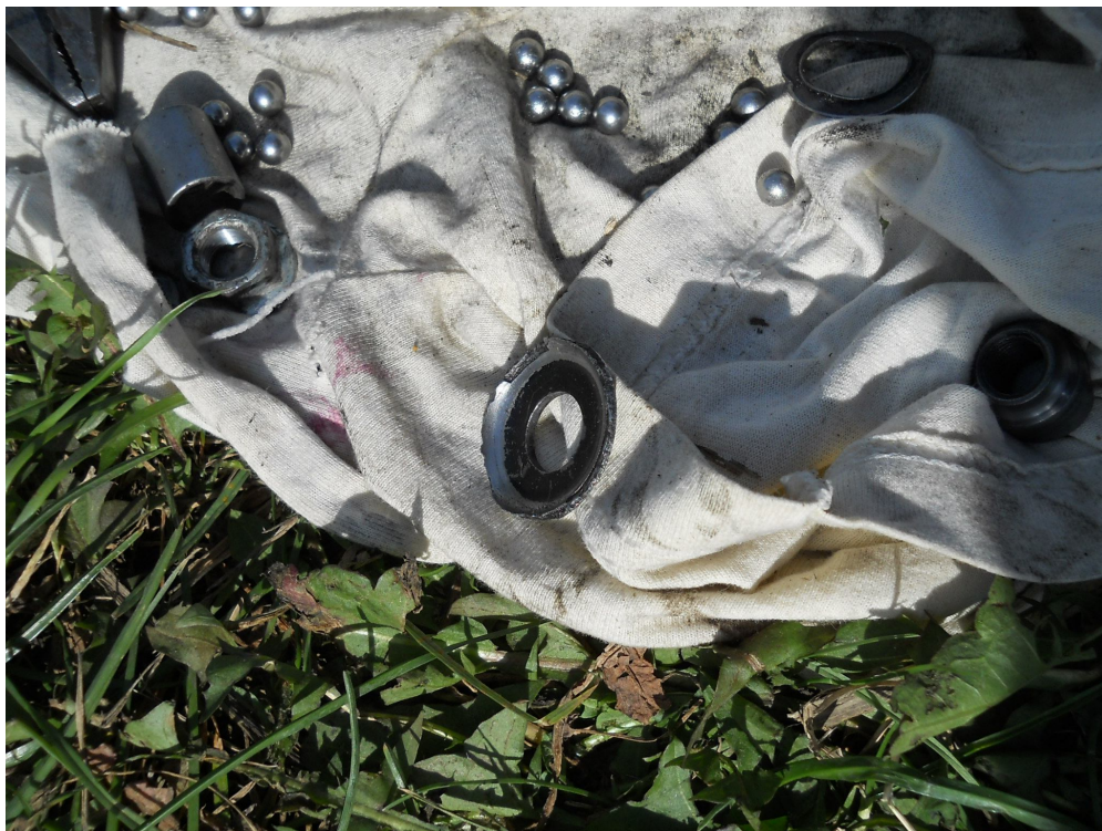
Фото 27. Составные части втулки. На переднем плане - дно перетертого стакана втулки.
